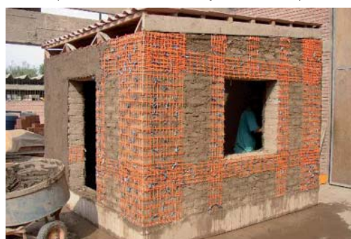
Figura 10. Módulo reforzado para ensayos de simulación sísmica. Lima, Perú. (Fuente: M. Blondet).
