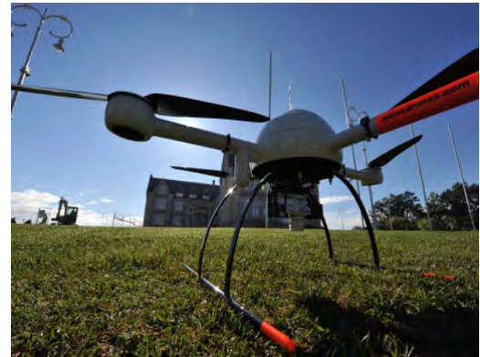
Figura 4. Multicóptero Microdrones Md-1000 (LFA).
