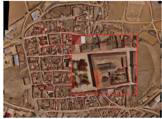
Figura 14. Superposición de ortofotografía y nube de puntos para el estudio de trazado.
