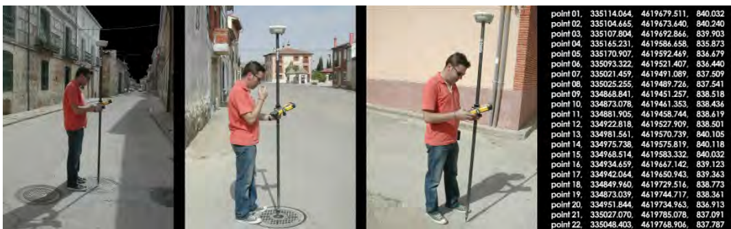
Figura 9. Apoyo topográfico sobre el terreno mediante estación GPS.
