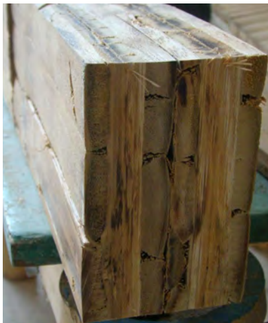
Figura 5. Vigas con latilla de caña, industria nacional. Con mayor resistencia que la madera más fuerte, eco-material sostenible Premio Internacional.
