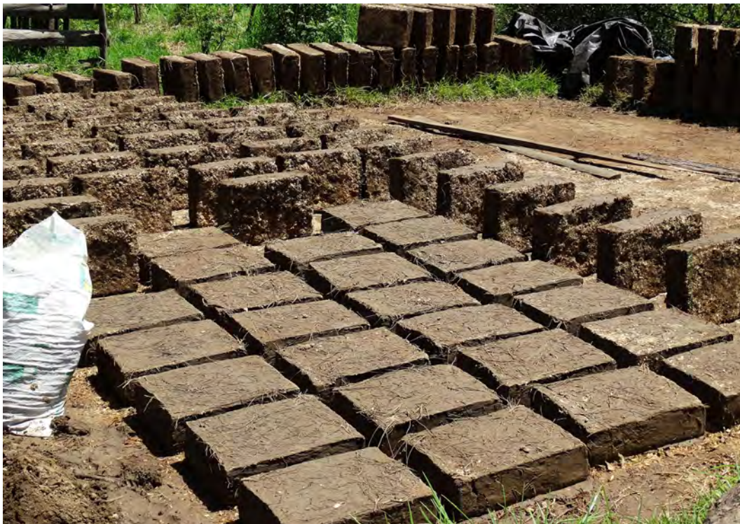
Figura 6. El secado de los adobes debe ser lento para evitar su agrietamiento. Fuente: Jaqueline Jiménez.
