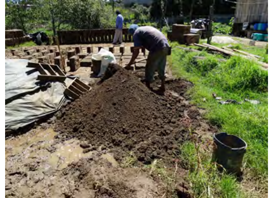
Figura 5. Mezclado de la tierra y la arena en seco. Fuente: Jaqueline Jiménez.
