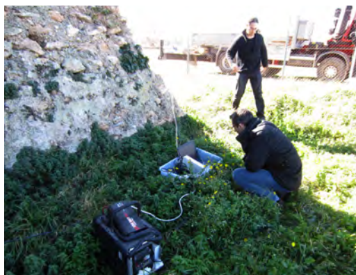
Figura 6. Preparación del equipo para la caracterización dinámica. Fuente: Teresa M. Pellicer.
