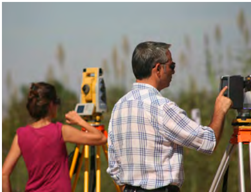
Figura 3. Levantamiento topográfico y con láser-escáner. Fuente: Pablo Rodríguez.
