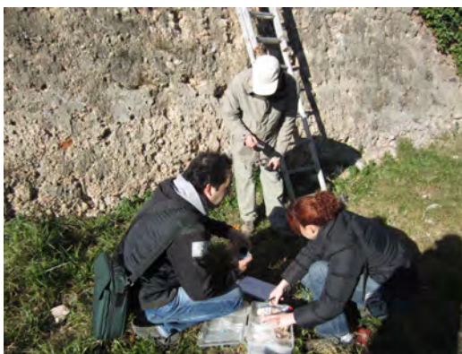
Figura 5. Toma de muestra de la tapia en el exterior de la torre. Fuente: Teresa M. Pellicer.
