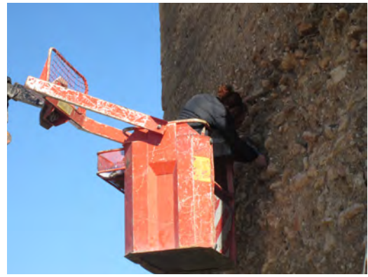
Figura 9. Toma de muestra de la tapia en el exterior de la torres. Fuente: Teresa M. Pellicer.
