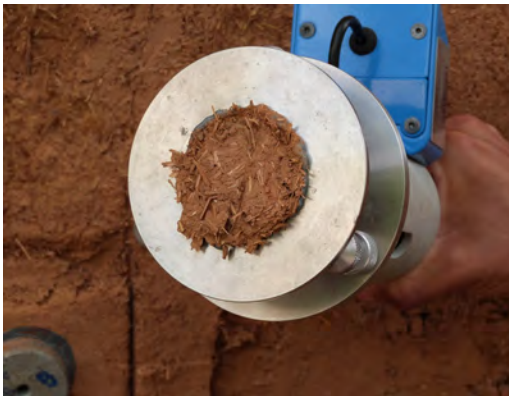
Figura 6. Ensayo de adherencia in situ.
