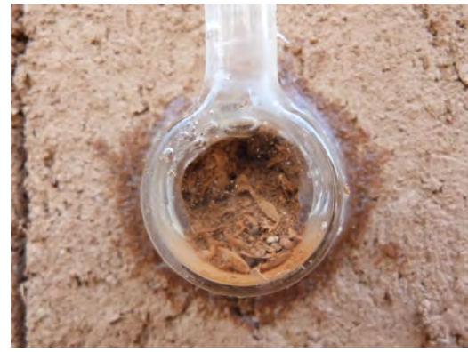
Figura 7. Ensayo de permeabilidad al agua líquida
