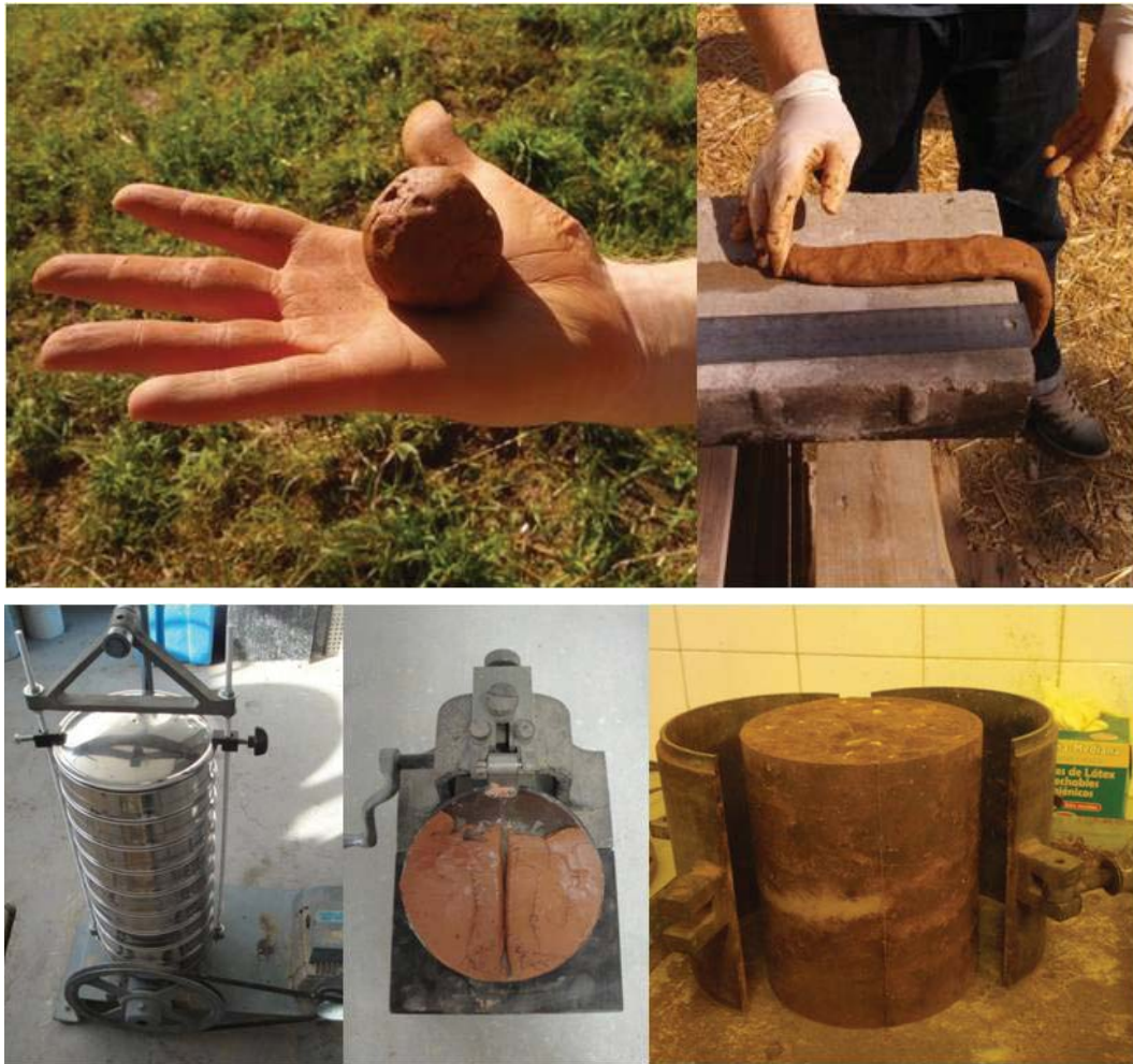
Figura 2 Ensayos organolépticos, granulométricos, cuchara de Casagrande y compactación "Proctor". Fuente: Allepuz, Poza.
