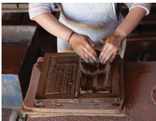
Figura 2. Processo de enforma de tijoleira 3X15X30cm. Telheiro da Encosta do Castelo. Fonte: Tiago Fróis. 2013.
