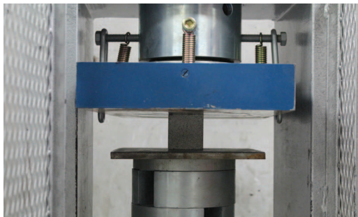
Figura 7. Proceso de pruebas mecánicas en Laboratorio UAM-Xochimilco, con prensa marca ELVEC mod. E 657-1. Fuente: Acervo del LABPySC FA/UNAM.
