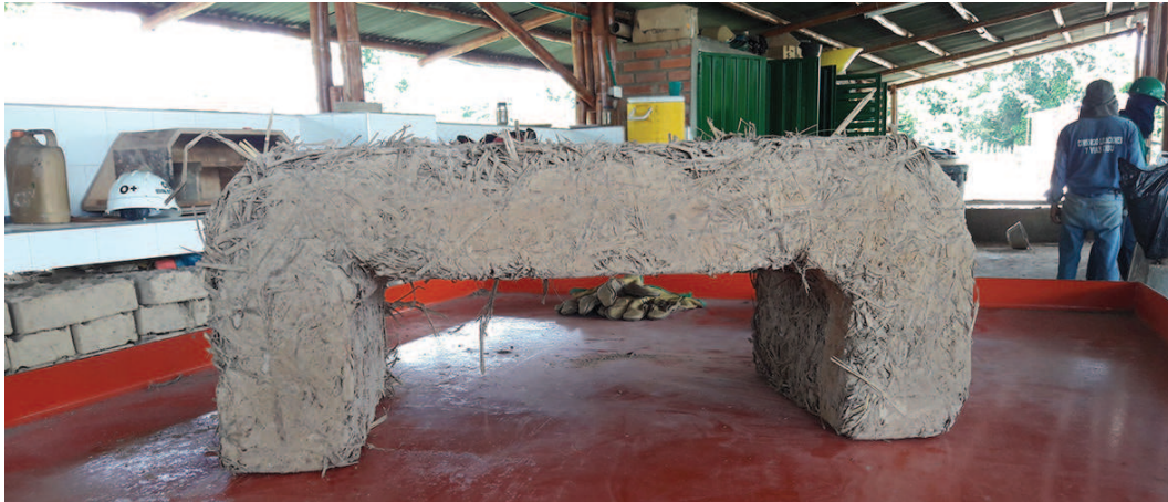
Figura 1. Casetón, aligerante para losas y entresijos elaborado con emulsión arcillosa y paja. Fuente: O. Hurtado y J.A. Cárdenas.
