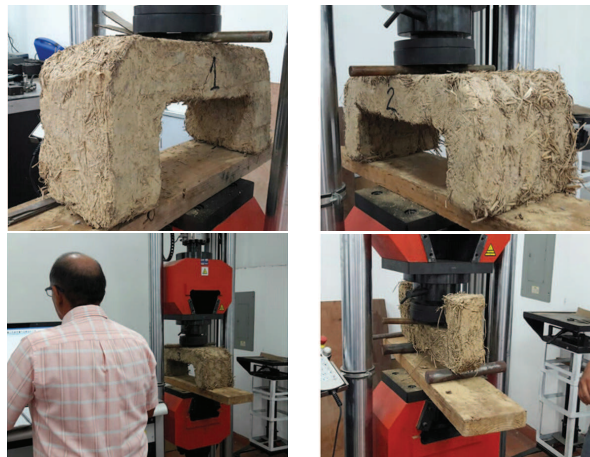
Figura 11. Ensayo a flexión. Fuente: O. Hurtado y J.A. Cárdenas.
