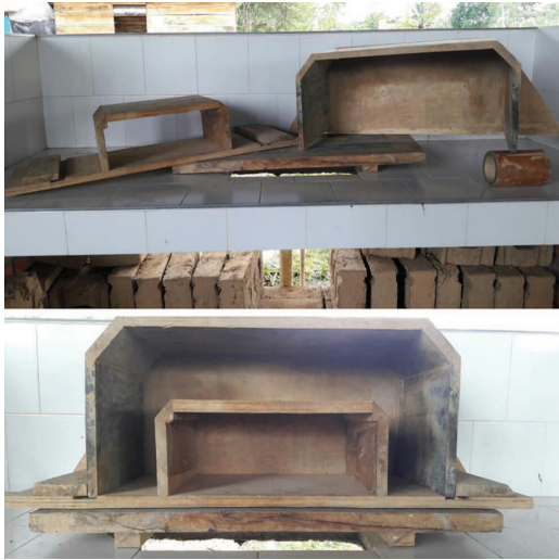
Figura 6. Molde en madera para el Casetón. Fuente: O. Hurtado y J.A. Cárdenas.
