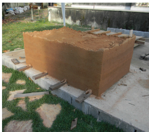
Figura 4. Miniparede em taipa de pilão. Fonte: Acervo da autora, 2016.
