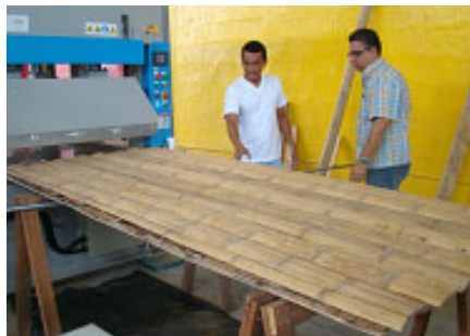
Figura 37. Ingreso del Tablero en la Prensa
