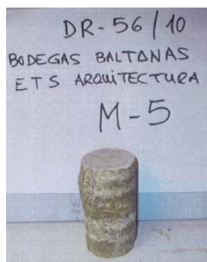
Figura 11. Probeta para rotura a compresión simple de la muestra de suelo BLT-M-5.
