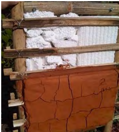
Figura 8: Propuesta del maestrante Carlos García de una pared de bahareque hecha con bambú y relleno con restos de poli-estireno expandido y barro Fuente: Carlos García.
