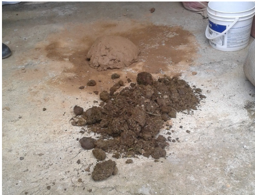
Figura 3. Cagajón (heces de caballo) en estado seco listo para utilizarse como material para la mezcla del revoque. Copacabana, Antioquia. Fuente: Propia
