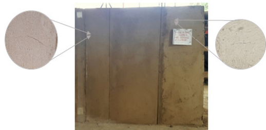
Ilustración 4 Muestras pañete en estado endurecido. Fuente: Elaboración propia. (López, 2017)
