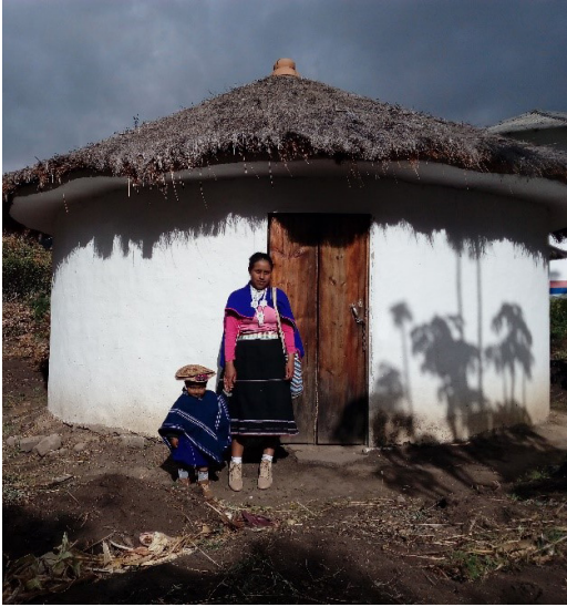
Figura 2: Representación de la casa tradicional Misak en Silvia (Cauca), originalmente era construida con muros en tierra y pintada con cal, cubierta en paja de loma. Fuente: El autor.
