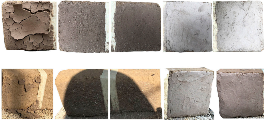
Figura 5. Probetas de revoque sobre adobes. Parte superior: se muestra el comportamiento pasadas un par de horas después de su aplicación. Parte Inferior: se muestra el comportamiento pasados 90 días después de estar sometidas al clima de verano con alto índice de lluvias. Fuente: Esmeralda Avila.
