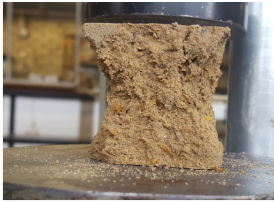
Ilustración 5 Falla de mortero tradicional y de suelo con cemento. Elaboración propia (López, 2017)
