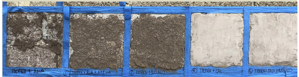
Probetas de revoque pasados 90 días, estas muestras estuvieron expuestas a la intemperie y fueron sometidas a constantes lluvias. En la imagen se muestra que la mezcla cinco es la que mejor se comporto ante factores atmosféricos.
