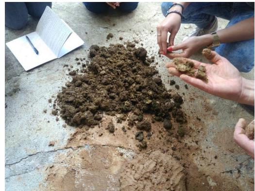
Figura 6. Proceso manual de desharinamiento del cagajón para obtener partículas más pequeñas. Fuente: Propia
