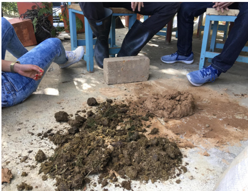
Figura 5. Cagajón y tierra previos a la preparación del revoco 30%-50% Suelo, 70%-50% Cagajón. Fuente: Propia
